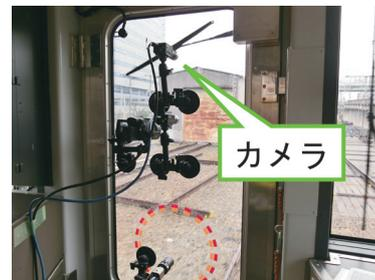
図6 評価試験における列車へのカメラ設置の様子
