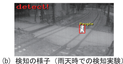
図2 遠赤外線画像式踏切内異常検知
