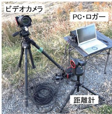
図1 ビデオによる多点同期振動測定システム
