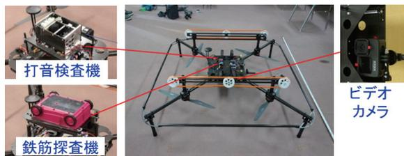
図11 構造物検査ドローンの実用化プロトタイプ
