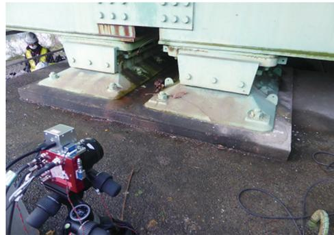
図5 鋼橋支承部の測定状況
