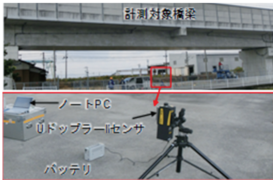
図9 抽出した橋りょうEの地上計測状況
