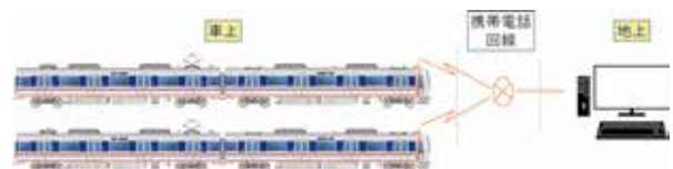
図4 車両情報記録装置のデータ収集システム 3)
