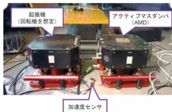
図2 試験車両への起振機およびAMDの設置状況
