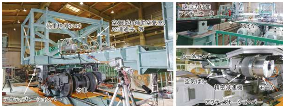
図5 定置傾斜試験の仮設状況
