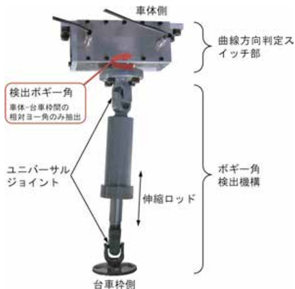
図7 逆・直線操舵防止機構
