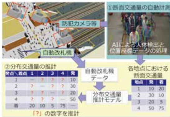
図2 分布交通量の自動推計手法の概念図
