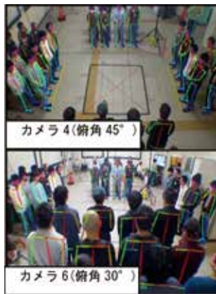
図5 AI人体骨格検出の出力例
