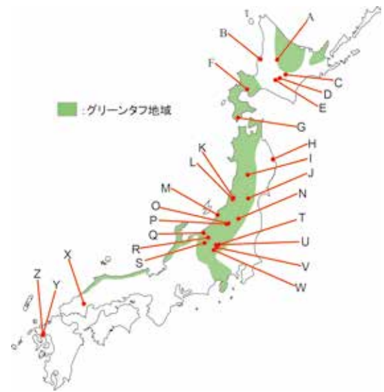
図3 盤ぶくれトンネルの地域的特性 2)
