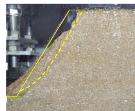
図4 破壊後の1:0.5勾配盛土
