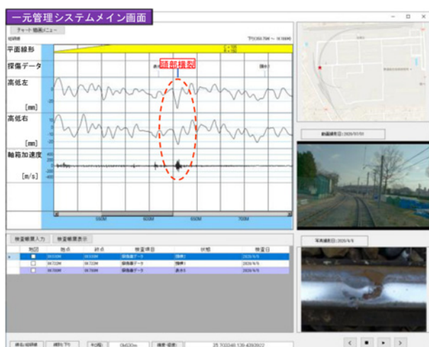
図8 一元管理システムのプロトタイプを活用した軌道検測データとレール探傷車データの一元化例
