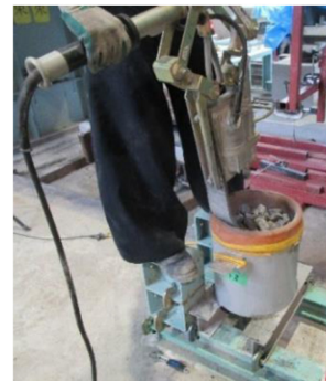
図5 HTTによるつき固め試験 5)
