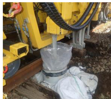
図6 MTTによるつき固め試験 7)
