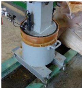
図 11 繰返し載荷試験の載荷状況 5)
