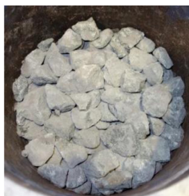
図 13 試験後のバラスト状態
