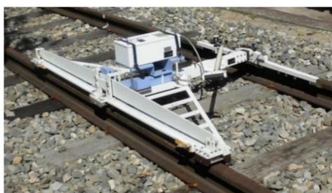
図4 簡易軌道検測装置<sup>5)</sup>
