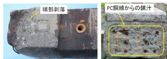
図1 PC まくらぎの塩害の例
