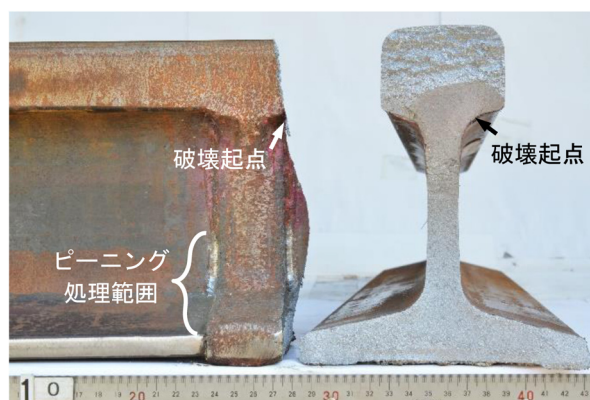
図 9 曲げ疲労試験で破断した試験体の一例（P-2）
