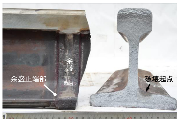
図1 テルミット溶接部の外観および曲げ疲労試験における破壊起点
