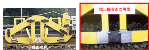
(a) 矯正機外観 (b) 治具取付状況
