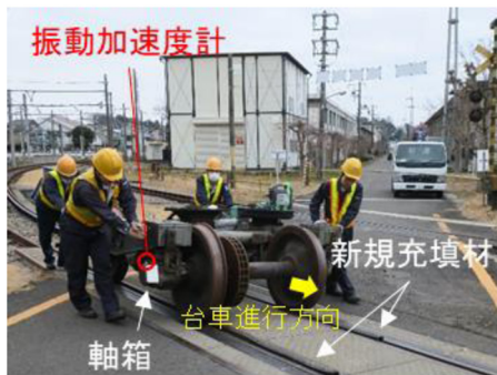
図6 台車走行への影響評価試験の様子
