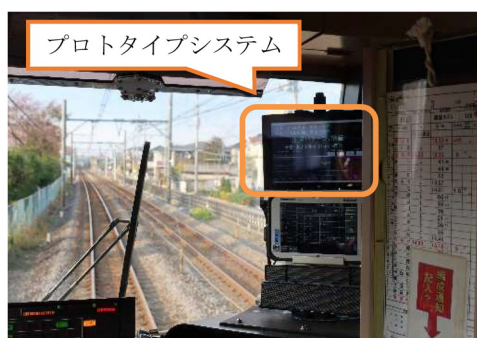
図6 走行試験での運転支援システム設置例
