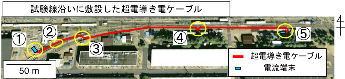
図6 300m 級超電導き電ケーブルの敷設箇所
