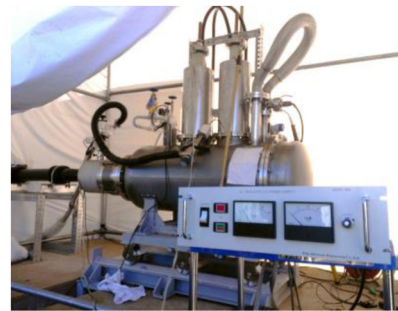
図 15 耐電圧試験の様子（西側端末）
