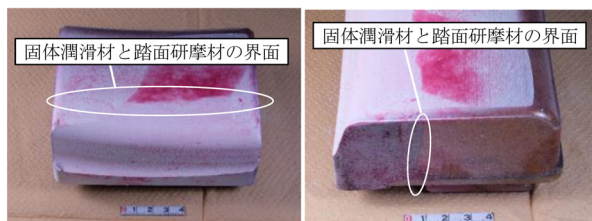
図7 繰返し接触耐久試験後の試験片の浸透探傷
