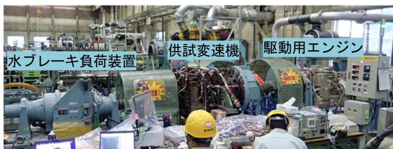
図 5 変速機異常模擬試験の状況
