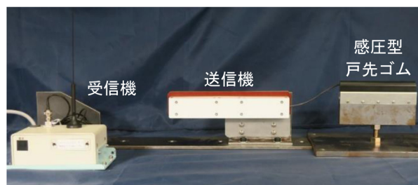
図 11 無線通知式検知システムの外観
