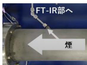
図4 プローブの挿入状態
