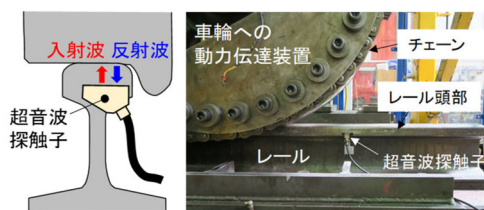
(a) 超音波による接触剛性の測定
