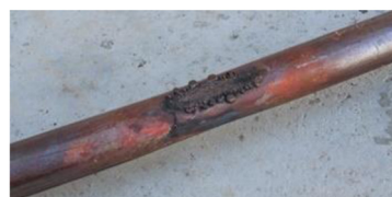
図8 アーク消弧後のトロリ線外観例
