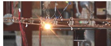
図 5 アーク消弧試験状況
