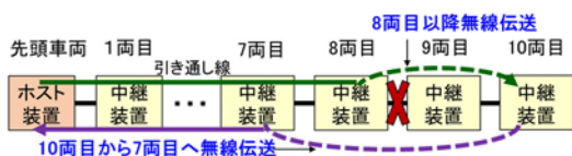
図7 ハイブリッド型車両間通信手法の伝送手順
