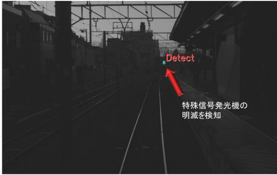
図 16 営業線において明滅を検知した例
