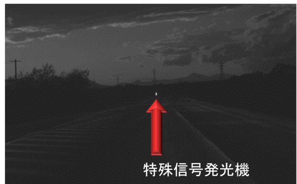
図4 バンドパスフィルタを使用して撮影した画像
