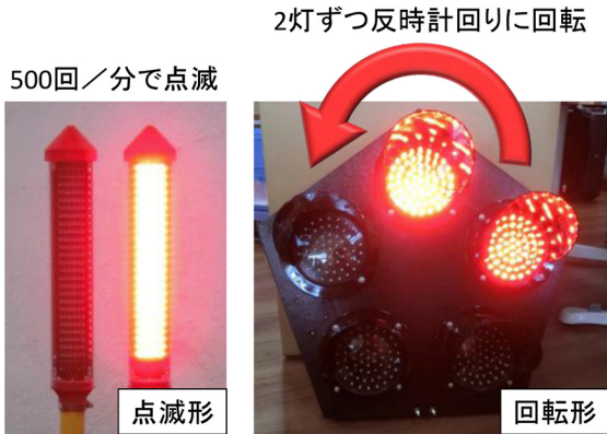
図2 点滅形と回転形の特特殊信号発光機
