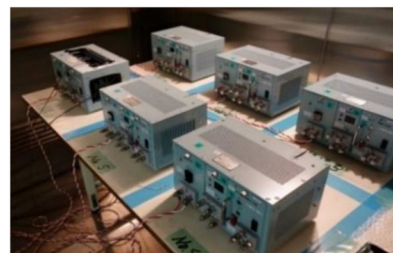
図5 恒温槽内の供試体
