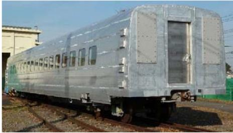
図 2 新幹線型試験車両
