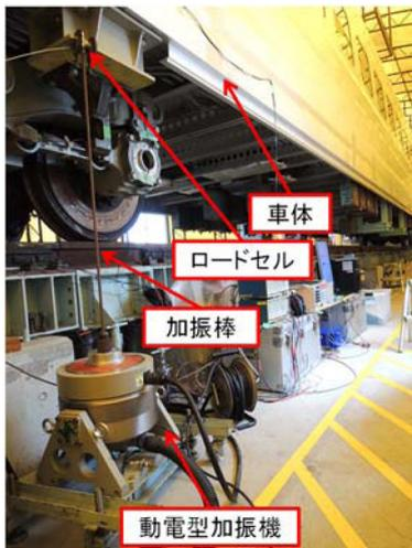
図 3 定置加振試験
