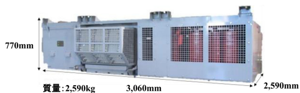
(a) 主変換部
