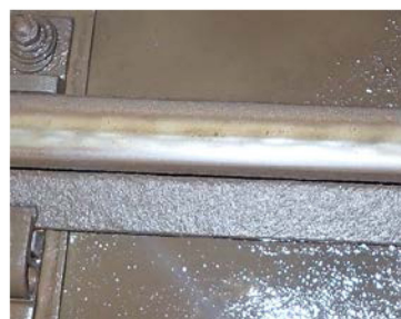
図5 波状摩耗の外観（営業線A） （①軸距間でのレール波動の干渉による例）
