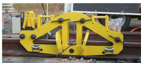
図2 レール頭部補修工法用の矯正機
