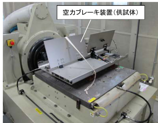
図8 振動試験の状況 (動作状態)
