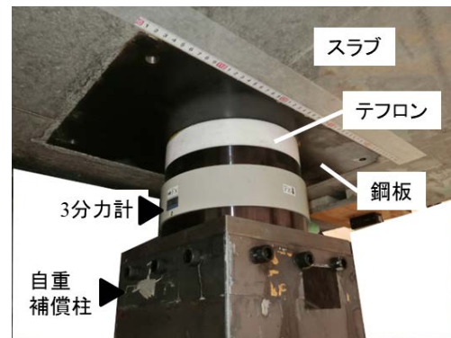
図4 自重補償柱頂部のすべり摩擦構造
