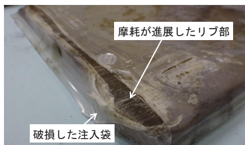
図10 試験後の可変パッド（タイプレート側）
