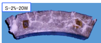
図13 「S-2%-20W」供試体の327日後の側面の様子
