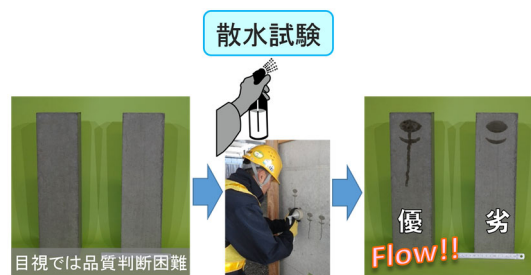
図3 コンクリートの簡易な品質評価方法
