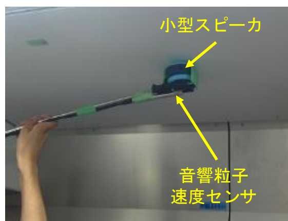
図8 小型スピーカ直近の音響粒子速度の測定状況
