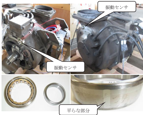
図5 供試電動機と供試軸受
