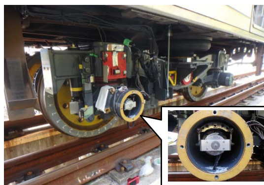
図9 試作スリップリング装置機能確認試験の様子
