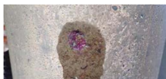
図10 中性化検査（アルカリ性の場合紫に発色）
