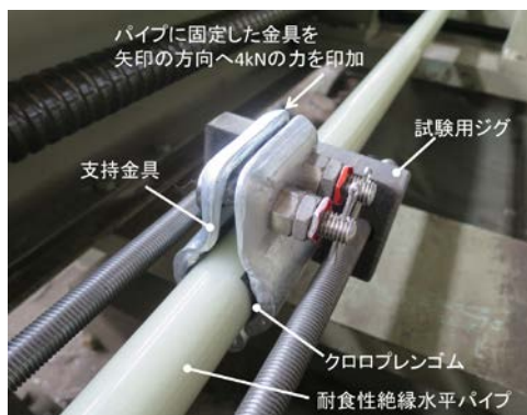
図4 耐滑り荷重試験（支持金具部拡大）
