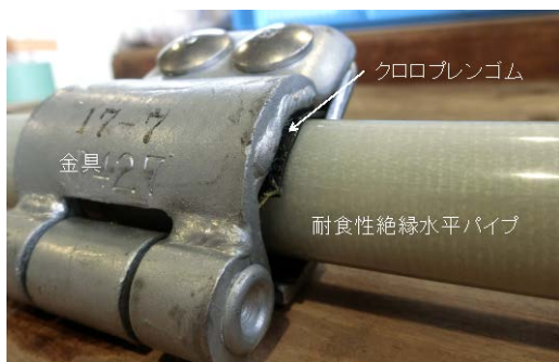
図3 試作絶縁水平パイプ提案品の構造
