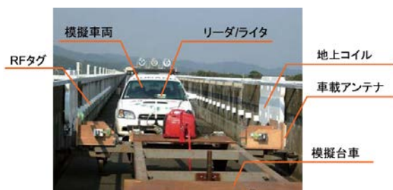
図5 模擬車両によるタグデータ読み取り試験 7)
