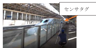
図8 BLE無線センサと新幹線のすれ違い通信
