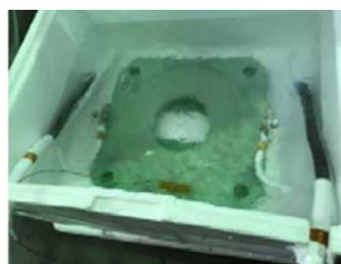
図 9 液体窒素浸漬による測定の様子
