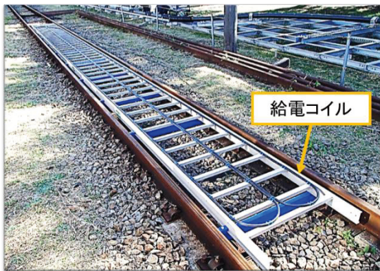
図2 原理実証システムの地上給電コイル
