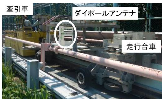
図9 低速牽引走行時の測定状況
