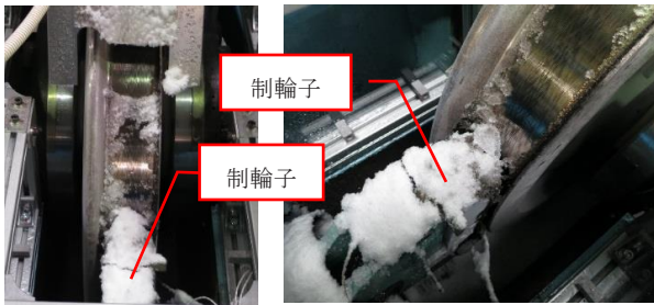
図3 冷却後の車輪と制輪子の外観
