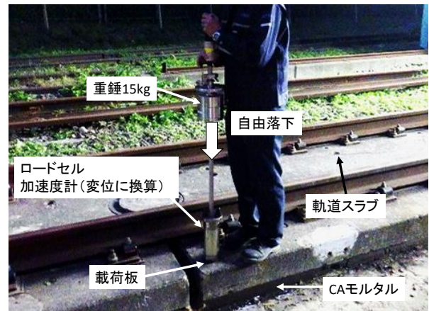
図5 小型 FWD 試験の状況
