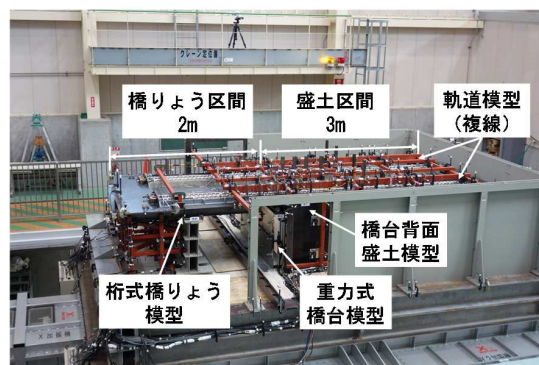
図 2 構造物・軌道一体模型の概要
